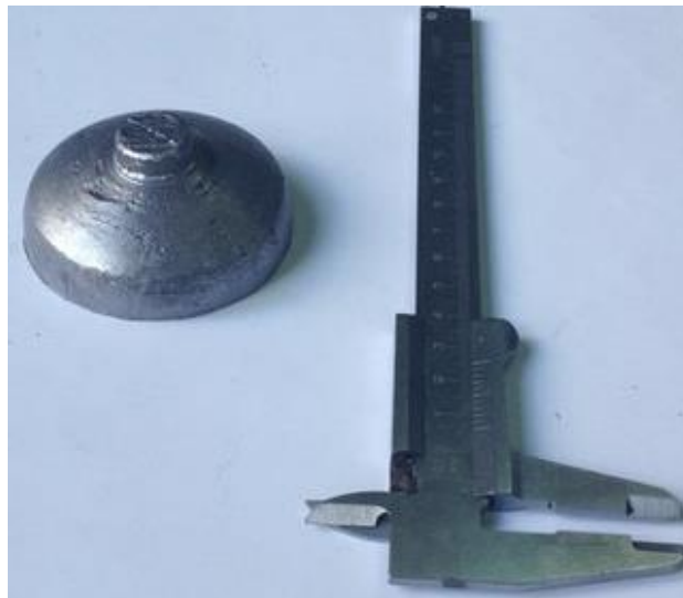
Рисунок 4.2 – Початкова заготовка до роздачі сферичною плитою (а), поковка після роздачі (б) та вид зверху (в)
