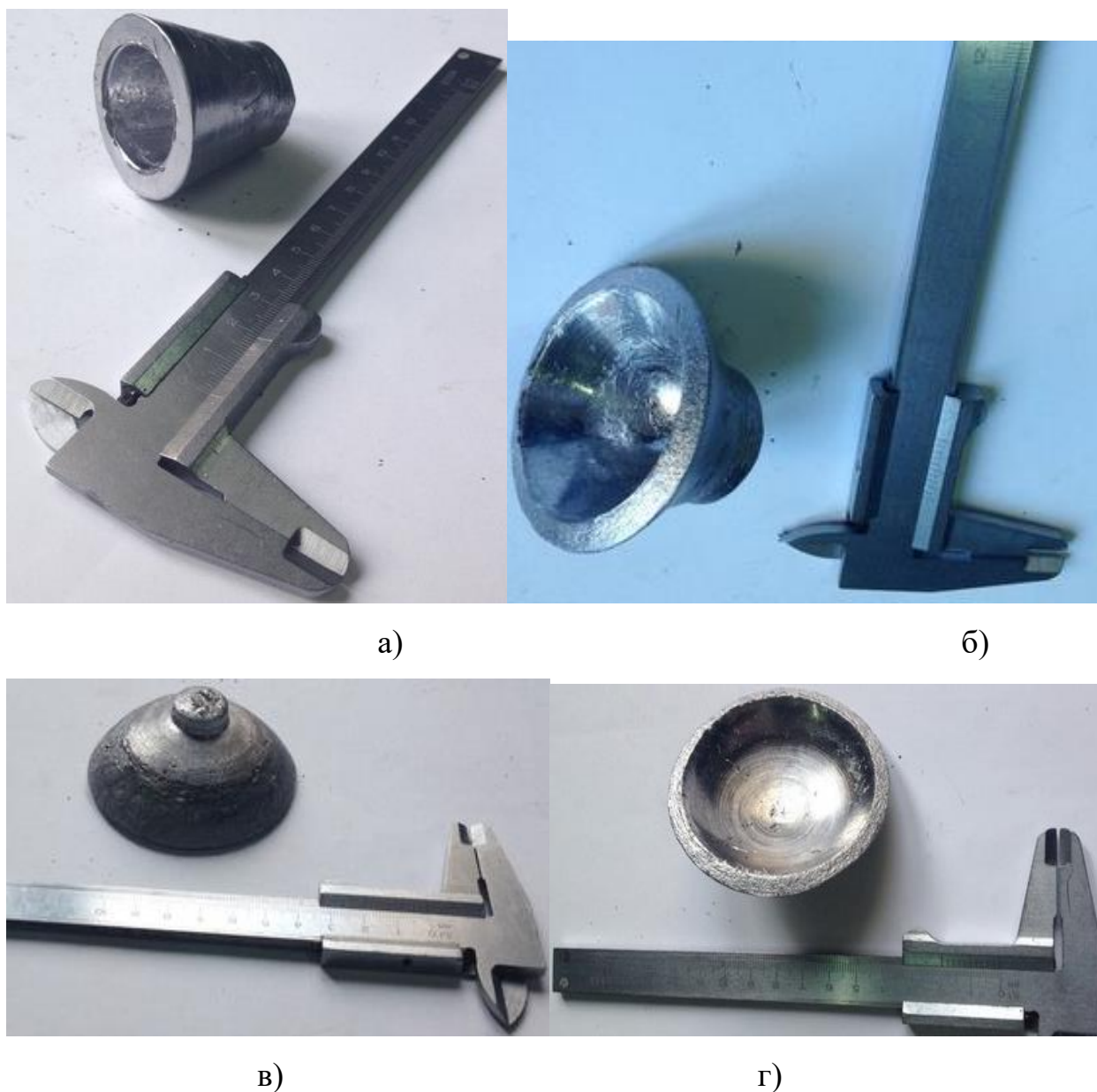
Рисунок 4.5 – Заготовки (а), після роздачі конусною плитою (б), після роздачі сферичною плитою (в, г)
