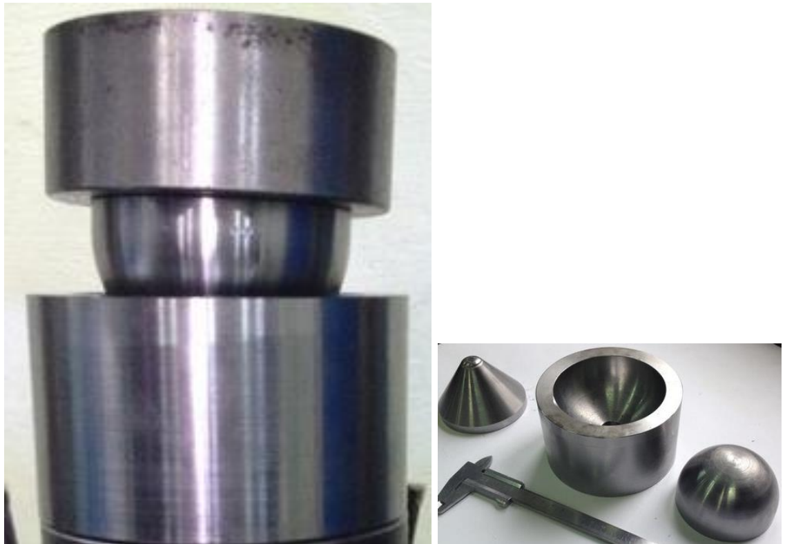
Рисунок 4.1 – Оснащення для процесу роздачі конусною та сферичною плитами
