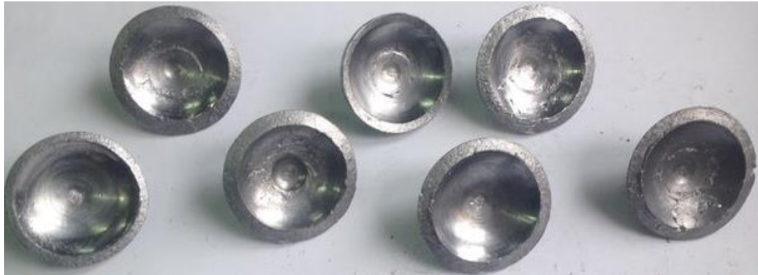
Рисунок 4.9 – Поковки відштамповані конусною та сферичною плитами
